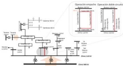
Con este circuito en operación, se presenta un aumento en la confiabilidad en la atención de la demanda la subárea Córdoba - Sucre al eliminar varias de las restricciones asociadas a límite térmico y por baja tensión, al pasar la capacidad de corriente del corredor, de 790 A con los circuitos empachados a 1160 A de capacidad del corredor con los circuitos por separado.
