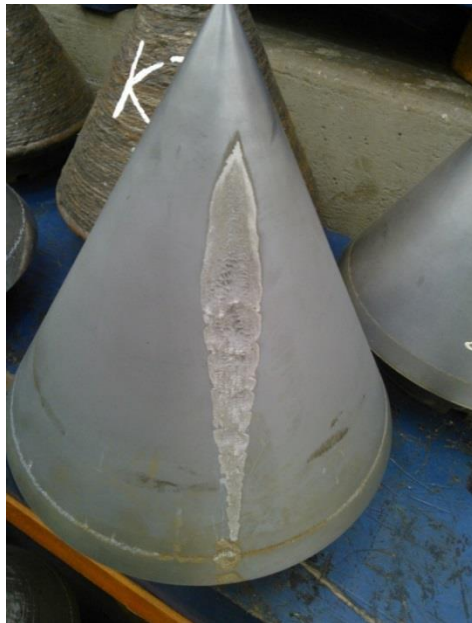
Aguja recubierta con WC-Co mediante HVOF después de 4000h de operación
