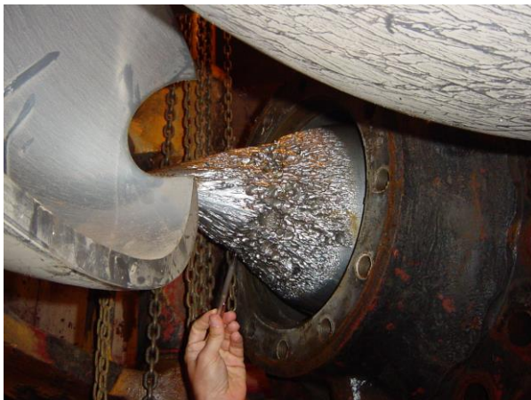
Desgaste de las superficies directoras de flujo.
